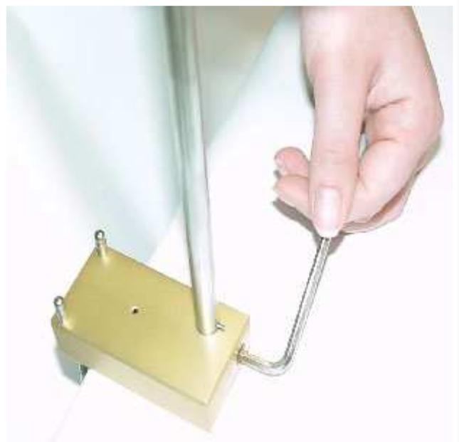
Setzen Sie die Handzange (1) mit den zwei sich an der Kopfseite befindlichen Aufnahmebohrungen in die Aufnahmestifte der Tischklemme. Befestigen Sie die Handzange indem Sie die Schraube an der Handzangenklemmung festziehen.
