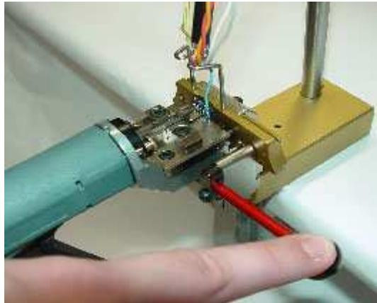
Wiederholen Sie die Kontaktierungen bis die erste Seite des Steckverbinders vollständig kontaktiert ist.
